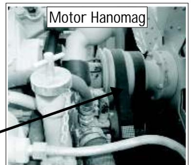
Revisar el estado de las correas del motor y del compresor del aire acondicionado y reemplazar si es necesario
