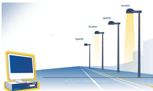
Sistema de control digital de los componentes instalado en el territorio
