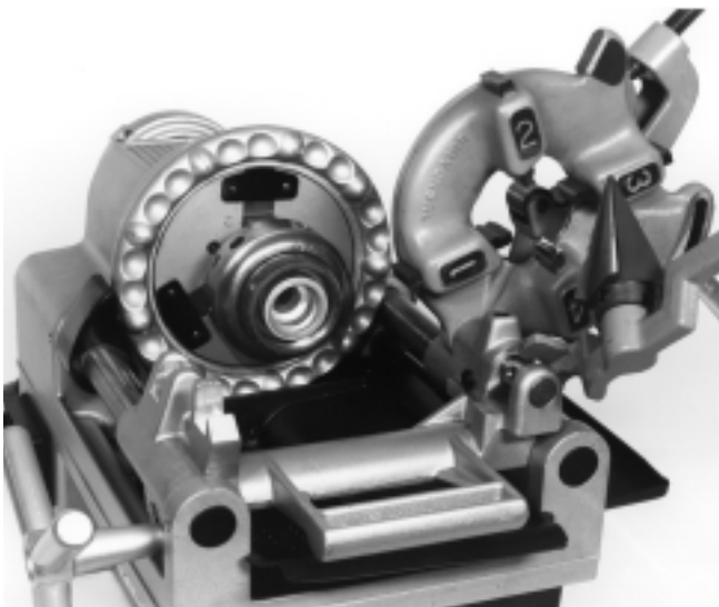
Figure 12 – Installez le mandrin à raccords sur le moteur d'entraînement
