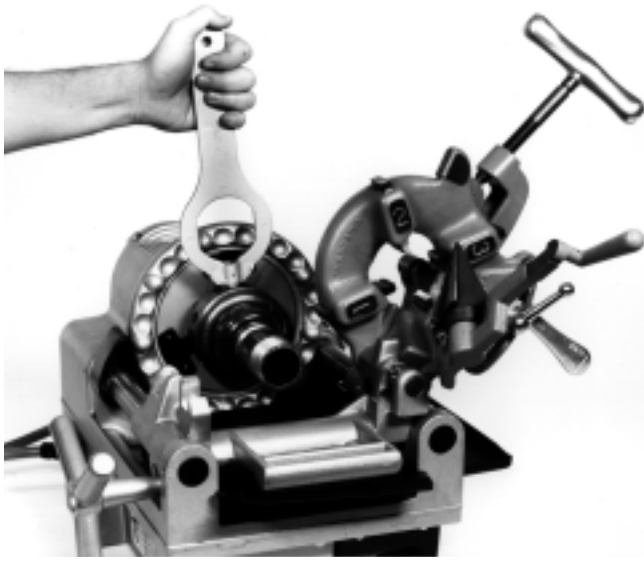
Figure 16 – Libération du raccord de l'adaptateur après son filetage
