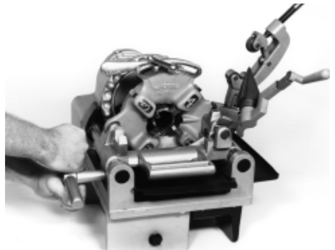
Figure 7 – Filetage des tuyaux à l'aide de la tête de filière No 811-A
