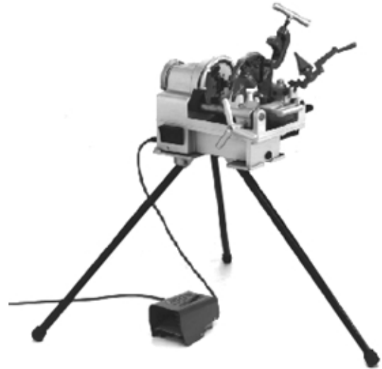
Figure 3 – Positionnement de l'appareil sur le support trépied
