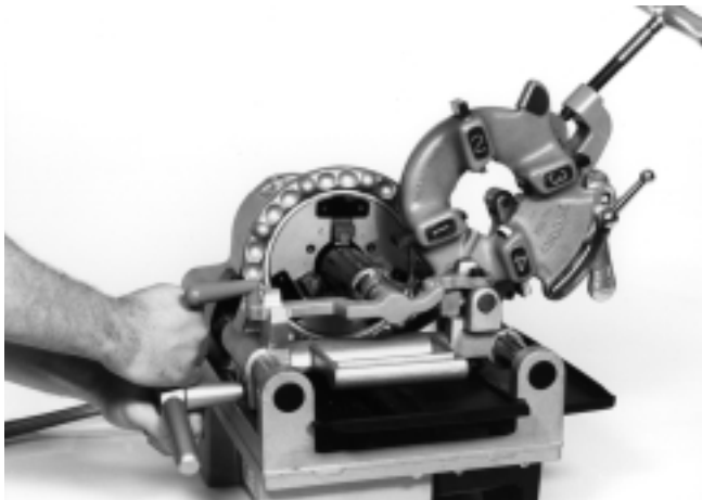
Figura 5 – El Escariado de Tubos con la Escariadora No. 323
