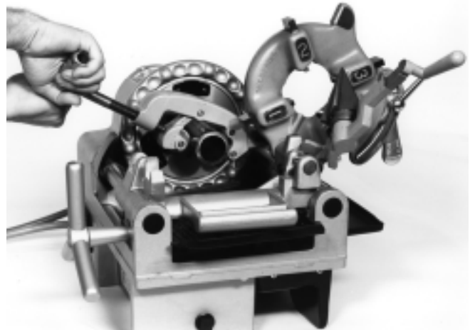
Figure 5 – Coupe de tuyau à l'aide du N° 732
