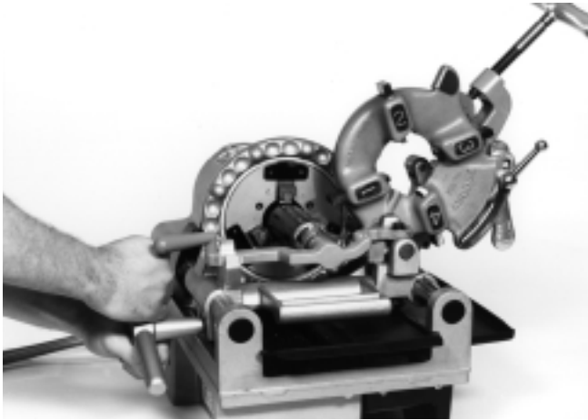
Figure 6 – Alésage d'un tuyau à l'aide de l'alésoir N° 323
