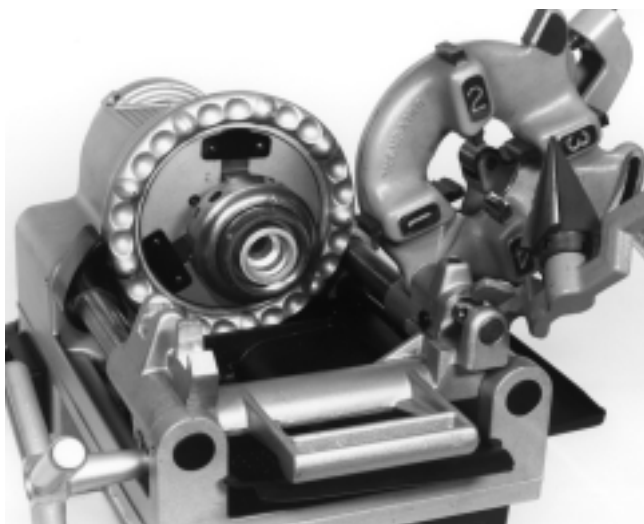
Figura 12 – Coloque el cuerpo del portaherramientas niplero en el accionamiento autopulsado
