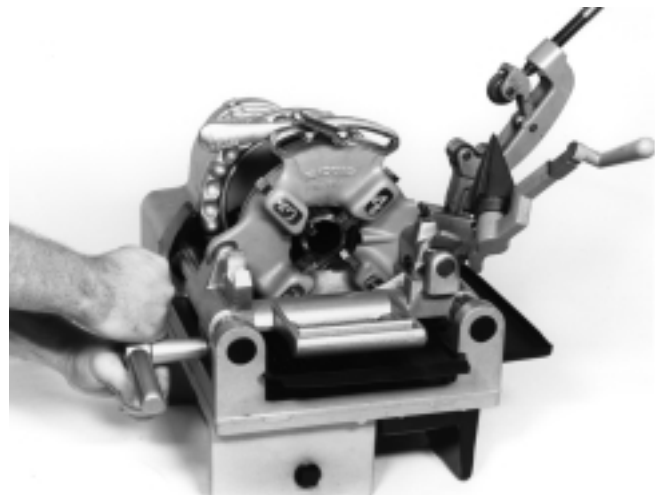
Figura 7 – El roscado de tubos con el cabezal de terrajas No. 811-A
