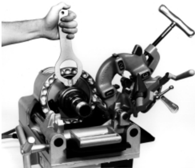
Figura 16 – Soltando el niple roscado del adaptador
