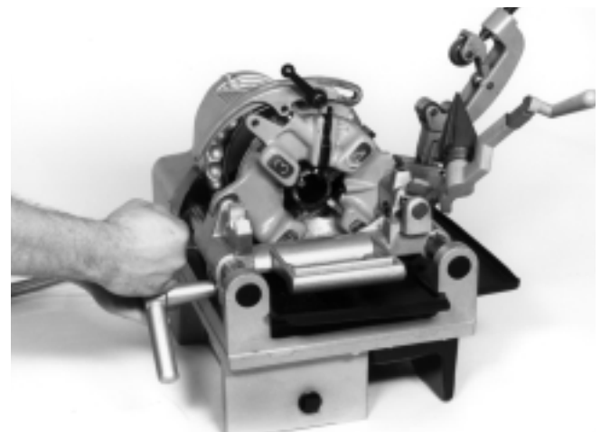
Figure 8 – Filetage des tuyaux à l'aide de la tête de filière à ouverture automatique N° 815-A
