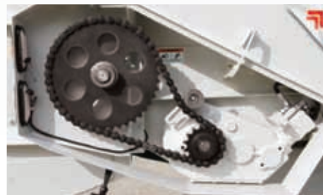
Caja de engranajes de ejes paralelos
