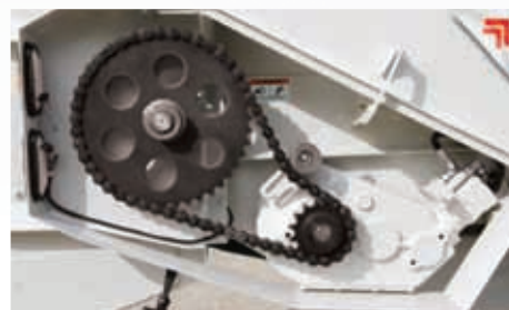
Caja de engranajes de ejes paralelos
