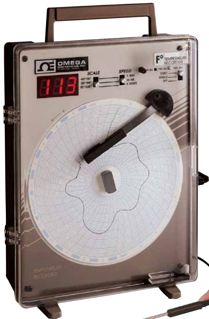
Registrador de temperatura baja CT87LF, con sonda CT87-J-NP (se incluye con los modelos CT87L).
