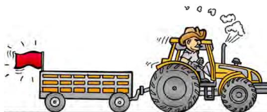
Cuando use el remolque la carga debe ser adecuadamente posicionada. La carga no debe obstruir la vista del operador o cubrir las luces y reflectores. Si la carga sobresale en más de un metro hacia atrás del remolque, la misma debe ser correctamente indicada con señales. Durante el día se puede usar una bandera y en la noche por medio de una luz roja o de reflectores.
