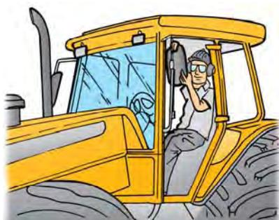
Verifique siempre, antes de manejar o transitar en carreteras, las condiciones de seguridad del tractor. Los espejos retrovisores deben ser correctamente ajustados para ofrecer el ángulo de visión correcto antes de iniciar la marcha.
