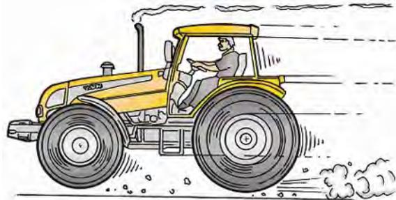
Adapte la velocidad del tractor de acuerdo con la superficie como también con las condiciones de visibilidad y la carga transportada. Evite frenadas o aumento brusco de la velocidad de funcionamiento, así como curvas cerradas en alta velocidad. Esto podrá causar el vuelco de la carga o del tractor.
