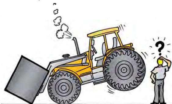
Cuando circule por una carretera, por lo menos el 20% del peso bruto del tractor debe estar apoyado en el eje delantero, para garantizar la estabilidad de la dirección. Se debe usar un número suficiente de contrapesos. Estos deben ser montados apenas en los locales designados para este propósito.
