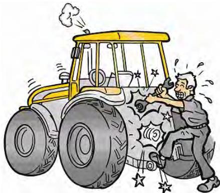
Manténgase lejos de componentes en movimiento, principalmente del motor y de la TDF. Cuando el eje de la TDF no esté siendo usado, mantenga el protector en su lugar. No efectúe operaciones de mantenimiento y/o ajuste cuando el motor está en funcionamiento.
