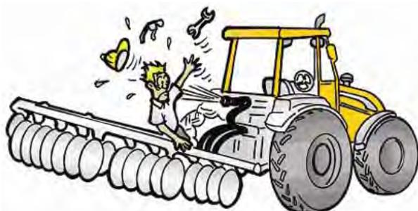
El sistema hidráulico funciona bajo alta presión. Cualquier fuga, por menor que sea, puede penetrar en el tejido del cuerpo humano.
