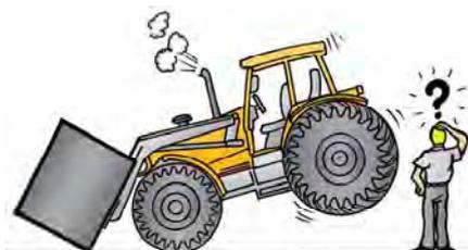
Cuando utilice un cargador frontal, no deje que nadie permanezca cerca del área de trabajo, hay peligro de que el tractor vuelque cuando la carga es elevada. El operador debe dejar el cargador al nivel del suelo antes de estacionar el tractor. Las instrucciones suministradas por el fabricante también deben ser cumplidas para evitar accidentes.
