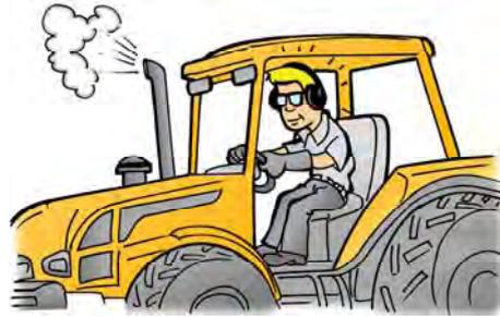
La operación con este tractor, en condiciones de carga parcial o total, expone al operador a un nivel de ruido continuo o intermitente superior a 85 db. (A), medido conforme el procedimiento de la Norma ABNT NBR 9999.
