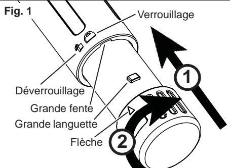
Aligner les grandes et petites languettes placées sur la batterie avec les grandes et petites fentes dans l'ouverture de l'outil. Insérer complètement la batterie dans l'outil. Tourner la batterie dans le sens horaire afin de la verrouiller dans le chargeur. La flèche sur la batterie s'alignera avec la sur l'outil.
