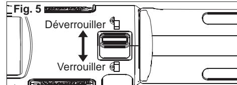
Lorsque la batterie est dans l'outil, celui-ci est prêt à fonctionner. Le verrou de rotation prévient les démarques accidentelles en bloquant l'inverseur de rotation. Placez toujours le verrou de rotation à la position marquée «LOCK» avant de faire l'entretien de l'outil, d'en changer les accessoires ou de le ranger lorsqu'il ne sert pas.
