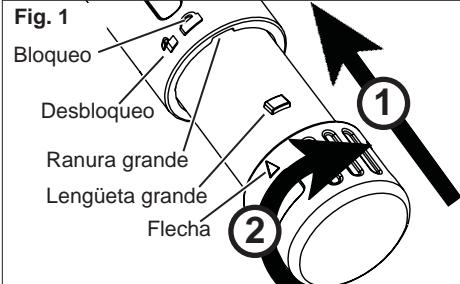
Alinee las lengüetas grande y pequeña de la batería con las ranuras grande y pequeña en la abertura de la herramienta. Deslice completamente la batería en la herramienta. Gire la batería en sentido horario para fijarla en su lugar. La flecha de la batería se alineará con el en la herramienta .
