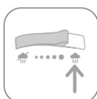
Para planchar con vapor, el ajuste de temperatura deberá encontrarse por encima de la posición \*\*.
