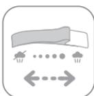
Retirar el enchufe de la red, verter el agua residual y colocar el regulador de vapor en la posición . A continuación, dejar enfriar la plancha.
