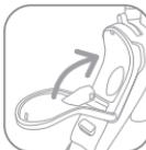
Tenez le fer à repasser en position oblique. Ouvrez l'orifice de remplissage. Versez de l'eau jusqu'au repère max. Fermez l'orifice de remplissage. Vous pouvez mettre le fer de nouveau à l'horizontal.
