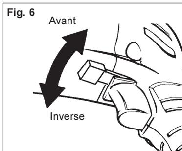
1. Pour la **rotation avant**, (sens horaire) poussez le levier inverseur vers la gauche (lorsqu'on regarde l'arrière, mettre de l'outil), tel qu'indiqué.
