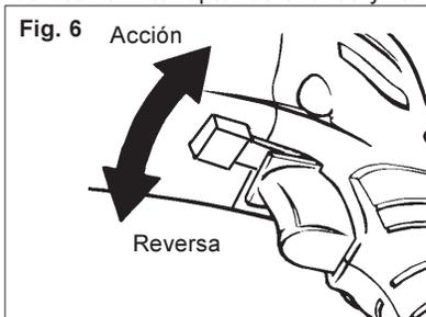
1. Para una rotación **positiva** (en el sentido de las manecillas de un reloj), empuje el interruptor de acción-reversa hasta la posición izquierda (vista desde la parte de atrás de la herramienta), como se ilustra.
