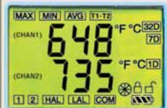
CTXL-DTC: pantalla local de termopar doble
