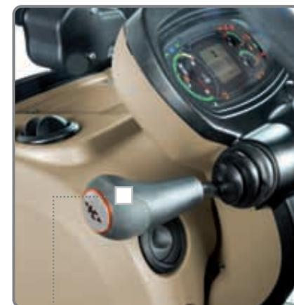
**Powershuttle** detiene el tractor e invierte el sentido de la marcha con el simple accionamiento de una palanca agilizando y facilitando la maniobrabilidad.
