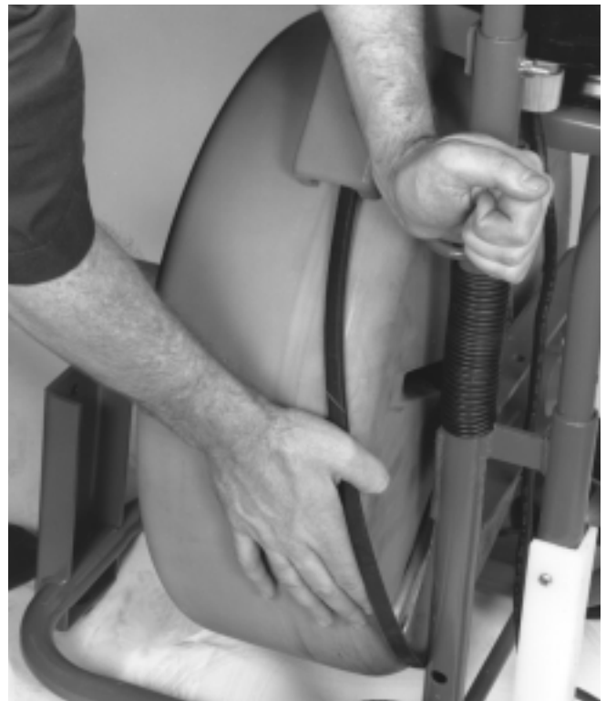
Figure 5 – Soulevez la courroie
