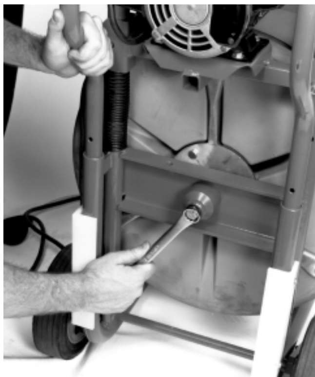
Figura 6 – Extracción del perno que sujeta el conjunto del tambor al bastidor de la máquina
