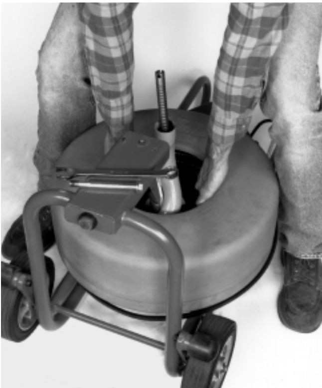
Figure 7 – Retirez le tambour de son point d'attache
