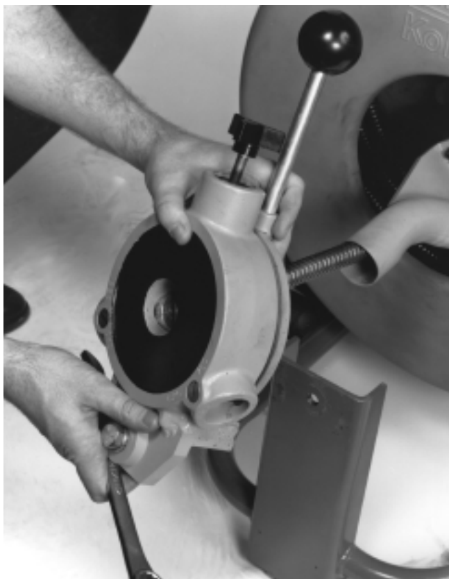
Figura 4b – Use una llave de 3/4" para extraer el conjunto de la alimentación propulsada
