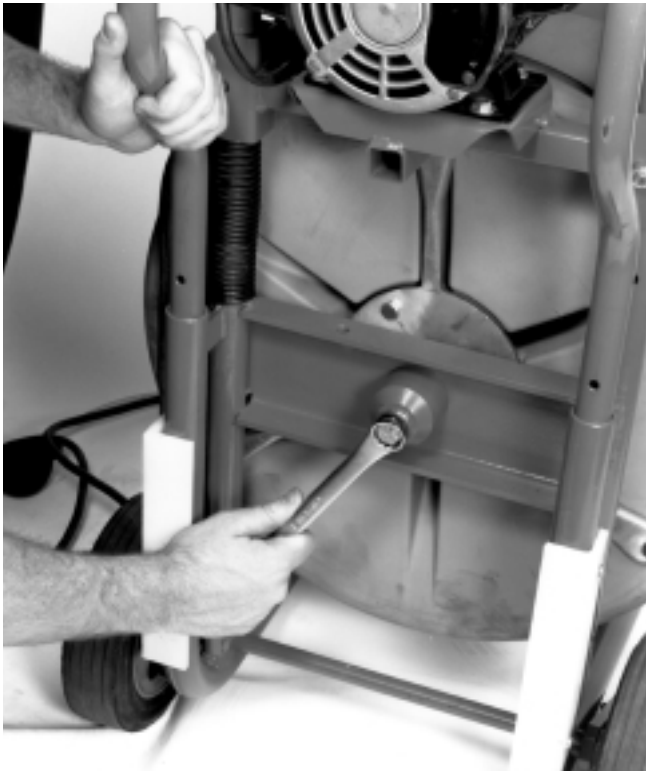
Figure 6 – Enlevez le boulon qui fixe le tambour au châssis de la machine
