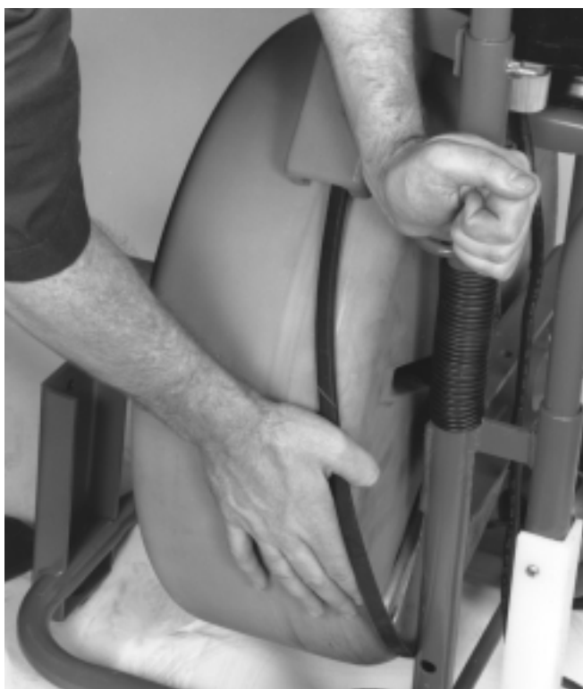
Figura 5 – Soltando la tensión de la correa
