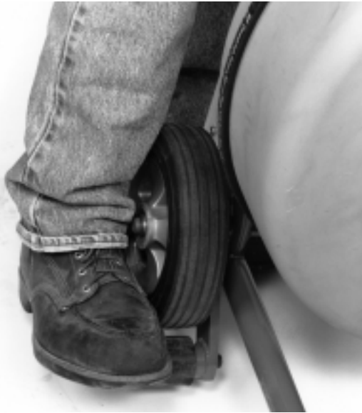
Figura 2 – Extender el soporte abatible.
