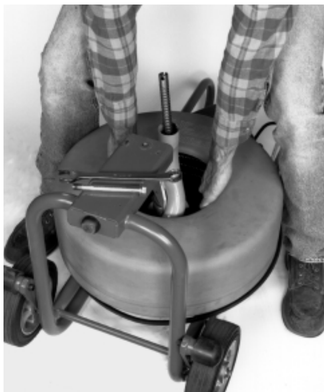
Figura 7 – Levantando el tambor de su posición de montaje
