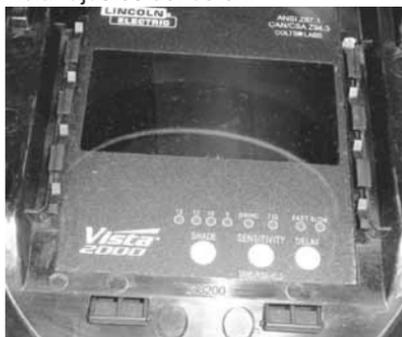
Pruebe su filtro ADF antes de soldar dirigiendo el frente del filtro hacia una fuente de luz brillante, después utilice sus dedos para cubrir y descubrir rápidamente los sensores. El filtro se oscurecerá momentáneamente ya que el sensor queda expuesto. También se puede utilizar un marcador de antorcha.
