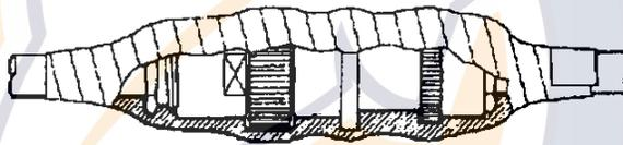
*Recubrimiento de la conexión coaxial*
