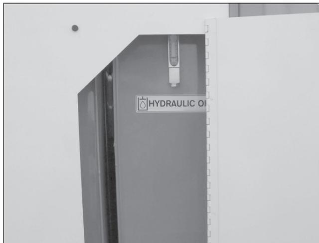
Figura 9 – Depósito de fluido hidráulico
