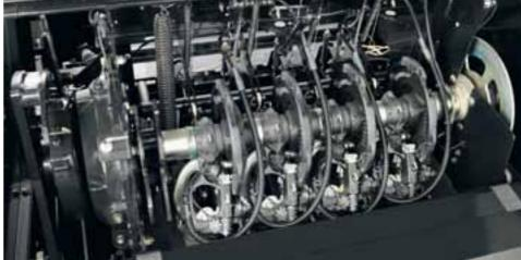
▲ Fiabilidad totalmente integrada. Las empacadoras LB Case IH cuentan con hasta seis anudadores reforzados (en función del modelo), diseñados para brindar un rendimiento óptimo en el anudado, paca tras paca. Unos potentes ventiladores mantienen los anudadores limpios para garantizar un funcionamiento constante al máximo de las prestaciones. Los amplios compartimientos laterales que pueden contener hasta 30 rollos de cuerda y una caja de herramientas.
