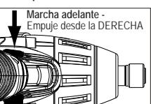
Para **retroceder** (el giro es en el sentido opuesto a las manecillas del reloj), se presiona el interruptor de control colocado al lado izquierdo del taladro. **Verificar la dirección del giro antes de usarlo.**
