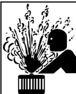
1.h. Para evitar quemarse con agua caliente, no quitar la tapa a presión del radiador mientras el motor está caliente.
