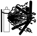
Si sufre algún daño, el CILINDRO puede explotar.
