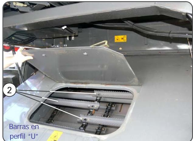
Tapa de inspección del canal alimentador
