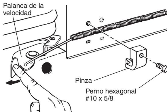
MOTOR DE BRIGGS Y STRATTON MOSTRADO (La pinza y los tornillos ya montados al motor Tecumseh)
