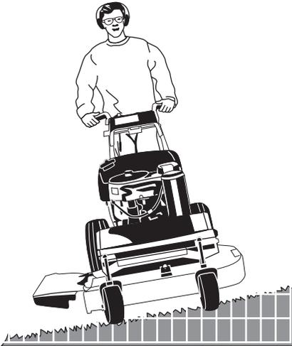
Usted puede salir gravemente lesionado si utiliza esta unidad en una pendiente demasiado pronunciada. Utilizar esta unidad en una pendiente que es demasiado pronunciada, donde no hace pie y la unidad no tiene tracción adecuada, puede hacer que pierda el control y que posiblemente se deslice y caiga o que se vuelque la unidad.
