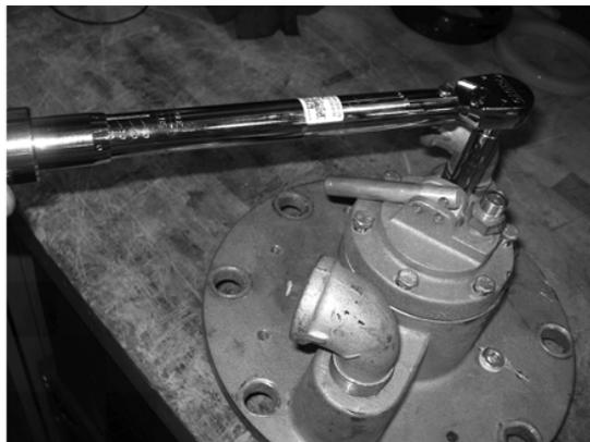
15. Opere la palanca manual para asegurar que el eje de la válvula tiene un rango completo de movimiento. Debe haber un ajuste perfecto alrededor del eje y del encaje de la válvula. Aplique una pequeña cantidad de grasa en el desatascador para operar la palanca manual.
