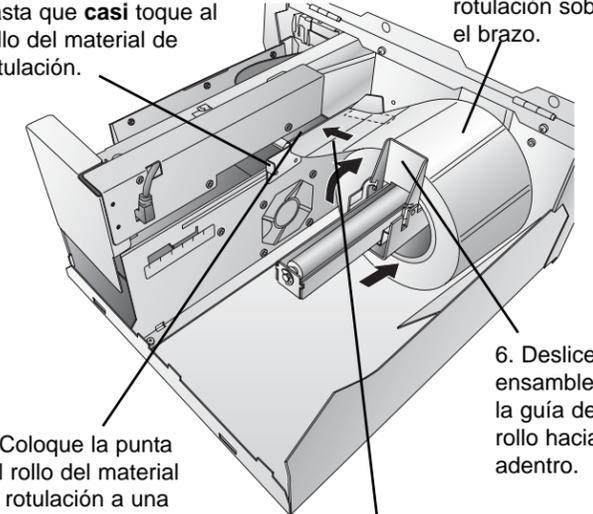
6. Deslice al ensamble de la guía del rollo hacia adentro.
