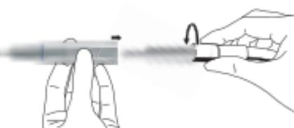
Premere il manipolo sul raccordo di tipo E del motore e farlo ruotare fino a quando non si sente che il bullone guida si è fissato in posizione. Prima dell'uso verificare ogni volta la connessione esercitando una trazione sul contrangolo per accettare che sia fissato saldamente.
