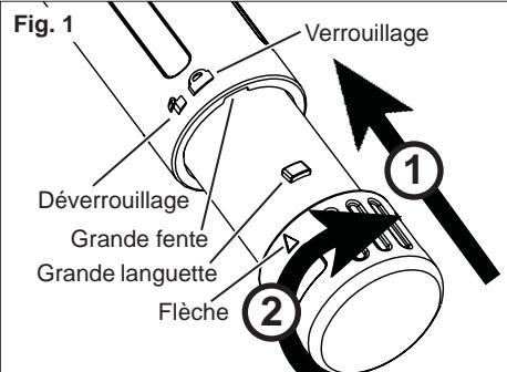
Aligner les grandes et petites languettes placées sur la batterie avec les grandes et petites fentes dans l'ouverture de l'outil. Insérer complètement la batterie dans l'outil. Tourner la batterie dans le sens horaire afin de la verrouiller dans le chargeur. La flèche sur la batterie s'alignera avec
