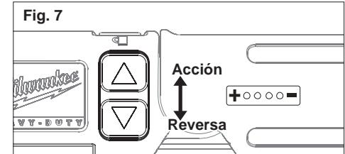
Presione y mantenga oprimido el interruptor de acción/reversa hacia arriba para la rotación hacia adelante y hacia abajo para la rotación en reversa. Cuando se libera el interruptor, este regresa automáticamente a la posición central, OFF.
