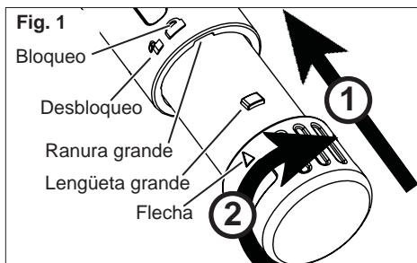
Alinee las lengüetas grande y pequeña de la batería con las ranuras grande y pequeña en la abertura de la herramienta. Deslice completamente la batería en la herramienta. Gire la batería en sentido horario para fijarla en su lugar. La flecha de la batería se alinearán con el en la herramienta .
