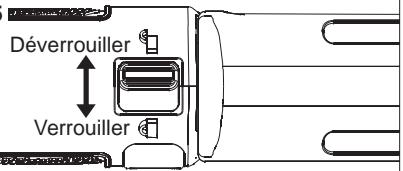
Lorsque la batterie est dans l'outil, celui-ci est prêt à fonctionner. Le verrou de rotation prévient les démarrages accidentels en bloquant l'inverseur de rotation. Placez toujours le verrou de rotation à la position marquée «LOCK» avant de faire l'entretien de l'outil, d'en changer les accessoires ou de le ranger lorsqu'il ne sert pas.
