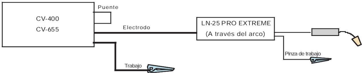
Coloque el interruptor CV/CC en el alimentador en la posición "CV".
