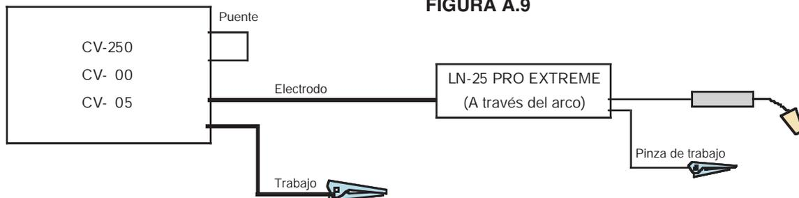
Coloque el interruptor CV/CC en el alimentador en la posición "CV".
