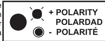
Utilice el LED de polaridad para verificar que el alimentador de alambre esté conectado para la polaridad correcta.
