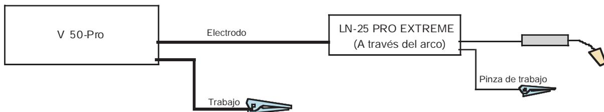
Coloque el interruptor CV/CC en el alimentador en la posición "CV".
