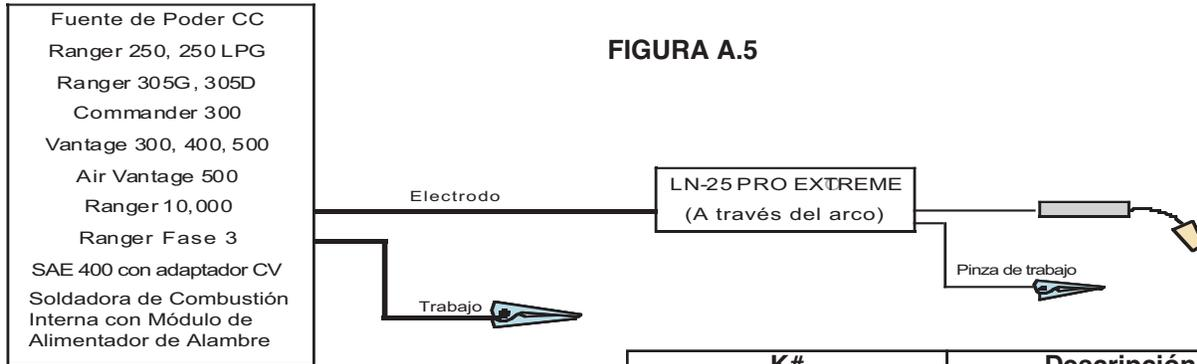
Si la fuente de poder tiene un interruptor Remoto/Local, coloque éste en la posición Local.
