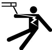
• LA DESCARGA ELÉCTRICA PUEDE CAUSAR LA MUERTE. A menos que utilice la función de ALIMENTACIÓN EN FRÍO, cuando alimente con el gatillo de la pistola, el electrodo y mecanismo de alimentación están siempre eléctricamente energizados y podrían permanecer así varios segundos después de que termina la soldadura.
