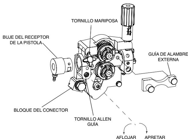
8. Conecte la manguera del gas protector al nuevo buje de la pistola, si se requiere.
