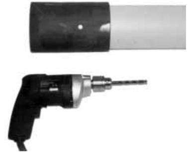
Sujete el tubo a la herramienta de expansión con tornillos y tuercas de 3/8". Use arandelas en cada extremo.
