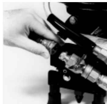
Figure 1 – Branchez le tuyau d'alimentation d'eau sur le dégorgeoir à pression. Fermez le robinet d'alimentation (montré en position fermée).
