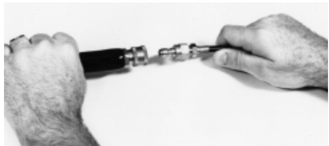
Figura 2 – Conecte la manguera de chorro al lavado de chorro
