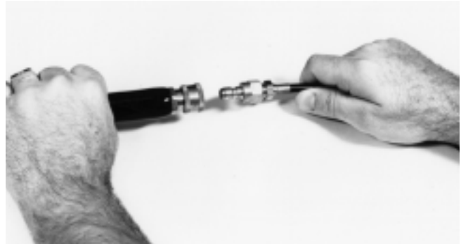
Figure 2 – Branchement d'un flexible sur le dégorgeoir à pression.
