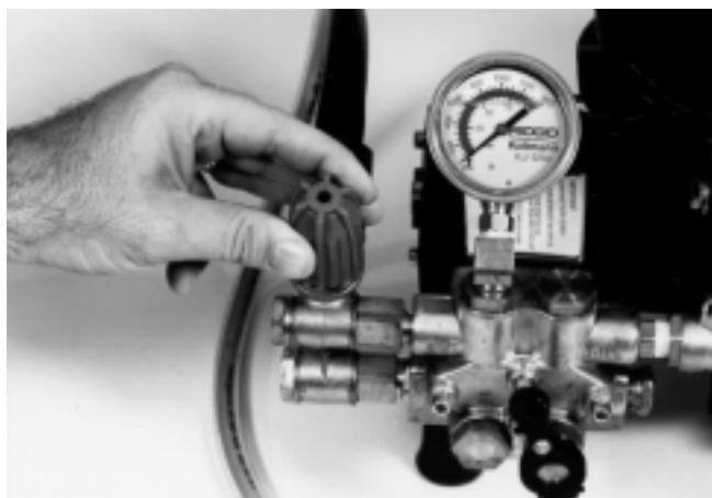
Figure 3 – Réglage du robinet de décompression
