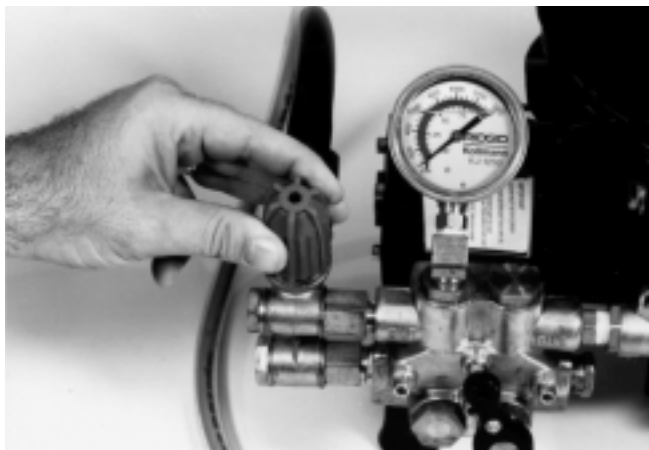
Figura 3 – Adapte la válvula de descarga
