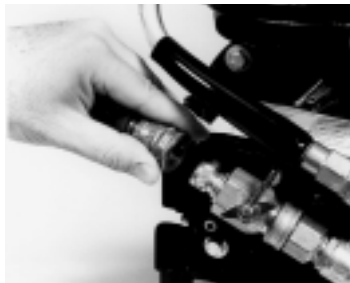
Figura 1 – Conecte el suministro de agua a la admisión de la unidad de lavado y cierre la válvula de suministro para la admisión (mostrada en su posición cerrada).
