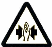
Existe riesgo de aplastamiento entre la barra de reacción y la pieza a apretar.
