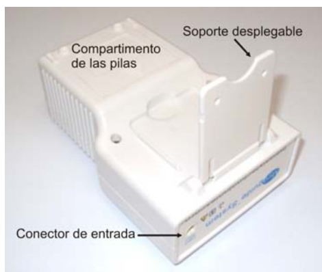
← Figura 2: Cara inferior de la unidad principal del Myoguide modelo 8008 de Intronix
