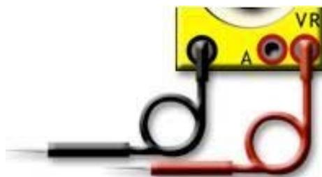
5. Coloque el terminal **rojo** del medidor en el terminal MTRR y el terminal **negro** del medidor en GND. El medidor debe indicar una resistencia infinita.
