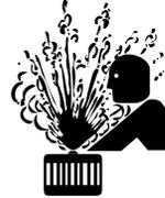
7.h. Para evitar quemarse con agua caliente, no quitar la tapa a presión del radiador mientras el motor está caliente.
