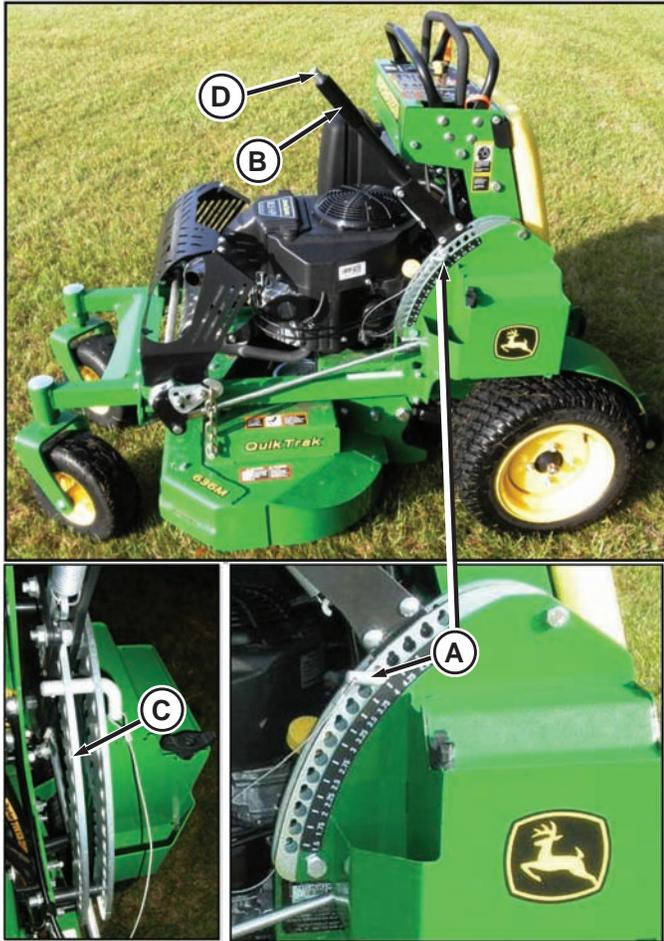
El pasador HOC (A) sirve de referencia rápida y es el punto en el que se detiene de la palanca HOC (B). La palanca HOC tiene una placa indizada en la parte trasera (C) que alinea la palanca con la selección de la HOC en la placa de la parte delantera.
