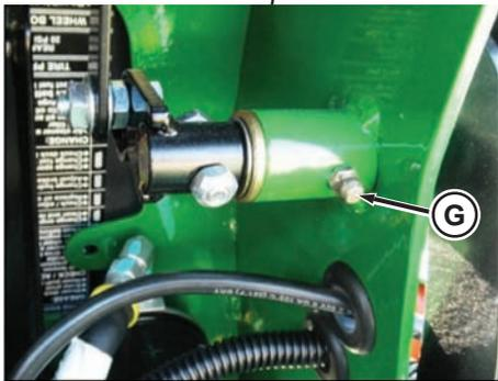
3. Asegurarse de que la articulación del freno (G) esté correctamente lubricada.
