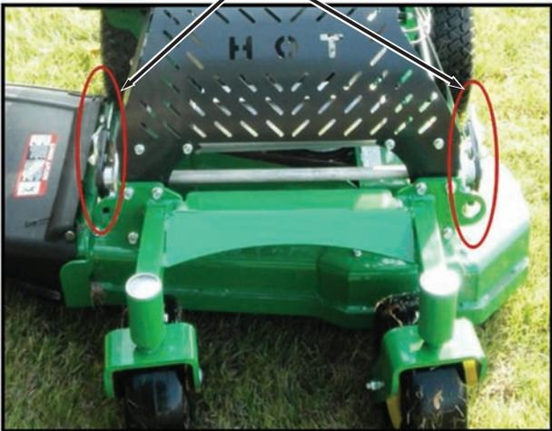
La plataforma se debe ajustar en cuatro puntos de elevación (C).
