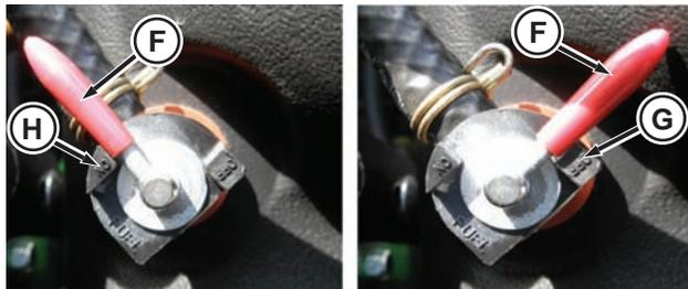
2. Girar la válvula de corte del combustible (F) desde la posición cerrada (G) hasta la posición abierta (H).
