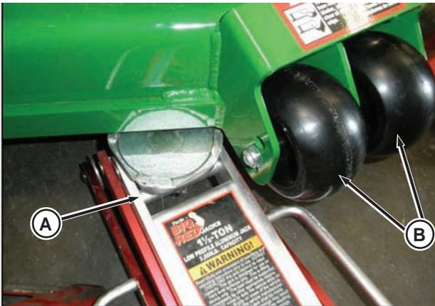
1. Colocar un gato (A) debajo del reborde de la plataforma de corte, cerca de las ruedas centrales antierosión (B).
