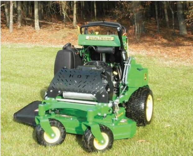
La facilidad de control de la transmisión hidrostática con dos palancas y el rendimiento del radio de giro cero real proporcionan al QuikTrak™ una gran capacidad de maniobra. Las barras de referencia delantera y trasera de los controles y la plataforma de suspensión ofrecen al operador una marcha suave y cómoda.
