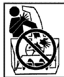
PELIGRO Pare el motor antes de desatascar el tubo de descarga.
