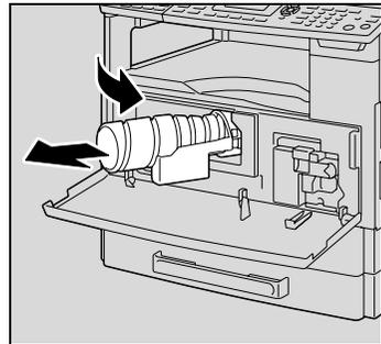
3 Mantenga el extremo sellado del nuevo bote de tóner hacia arriba y tire lentamente del precinto hacia usted.
