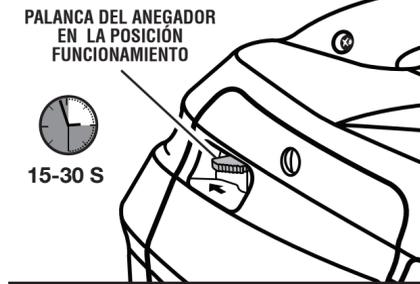
PALANCA DEL ANEGADOR EN LA POSICIÓN FUNCIONAMIENTO
