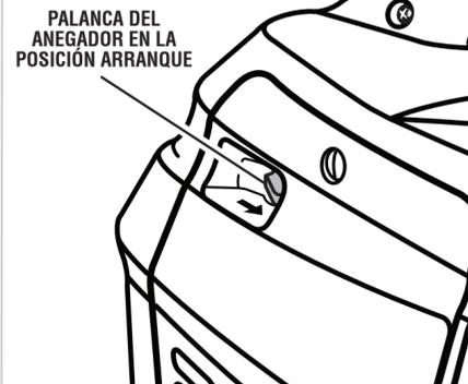
PALANCA DEL ANEGADOR EN LA POSICIÓN ARRANQUE
