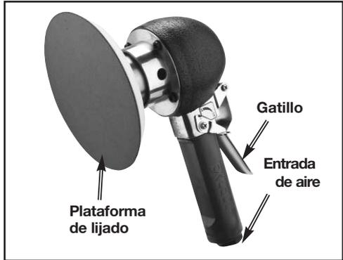
**IMPORTANTE:** La herramienta DEBE estar en posición de bloqueo para poder instalar la plataforma de lijado.
