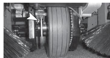
**5.** Verifique las condiciones y la tensión de las correas y las cadenas. Lubrique las cadenas con aceite para motores SAE 30.
