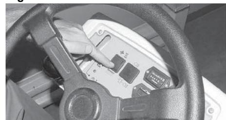
**2.** Apague el interruptor, coloque el freno de estacionamiento y vacíe la caja para residuos.
