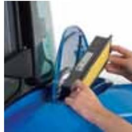
Para sustituir o limpiar el filtro de aire de la cabina, es suficiente desmontarlo de su cómoda posición en el guardabarros.
