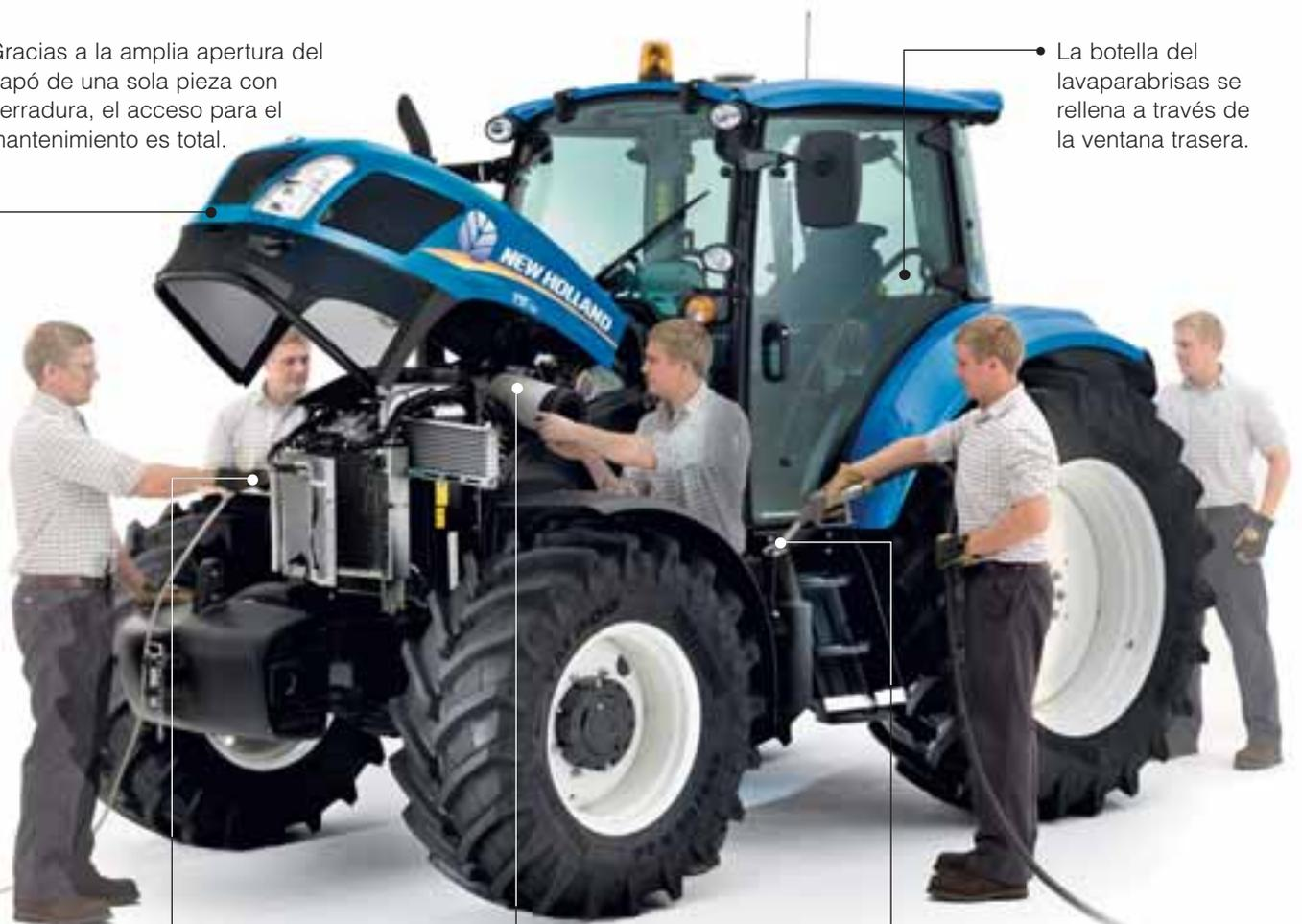
El sistema de refrigeración se abre para permitir una limpieza fácil y eficiente.
