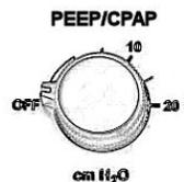
Control PEEP/CPAP, calibrado, rango de 0 a 20 cm de H<sub>2</sub>O
