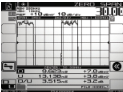
Modo experto "zero span" en el dominio del tiempo que muestra la rampa de 3,5 ms de la señal TDMA del cable-módem en el canal ascendente
