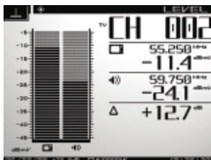
La presentación monocanal muestra los niveles de vídeo y audio (sonido mono o dual/NICAM) y la diferencia entre ambos
