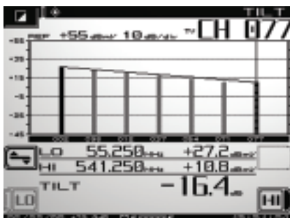
El modo tilt compara automáticamente dos de las nueve portadoras designadas
