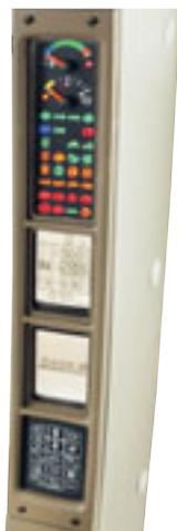
Si instala un receptor GPS, el monitor AFS Pro 600 con pantalla táctil en color trazará mapas de rendimiento sobre la marcha. En combinación con el sistema de dirección automática AccuGuide, también podrá mejorar la precisión de la conducción.
