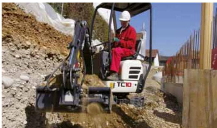
Nuestro sistema de pluma ajustable Knickmatik® permite excavar directamente a lo largo de muros.
