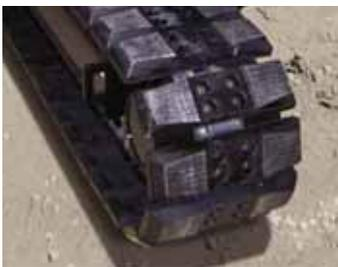
Con el fin de gestionar los costes, únicamente la zapata de caucho de las orugas de acero debe sustituirse por desgaste, en lugar de toda la oruga como en el caso de las orugas de caucho.
