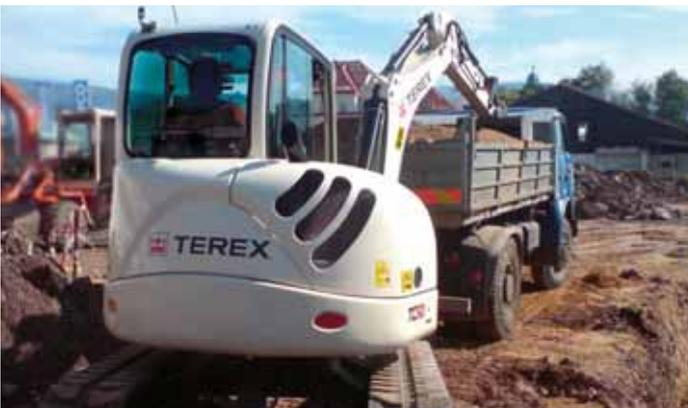
El conductor podrá acercarse al camión o incluso apoyar la pluma contra el lateral de la tolva o el remolque de carga sin dañar el cilindro, con lo cual la productividad se ve incrementada.
