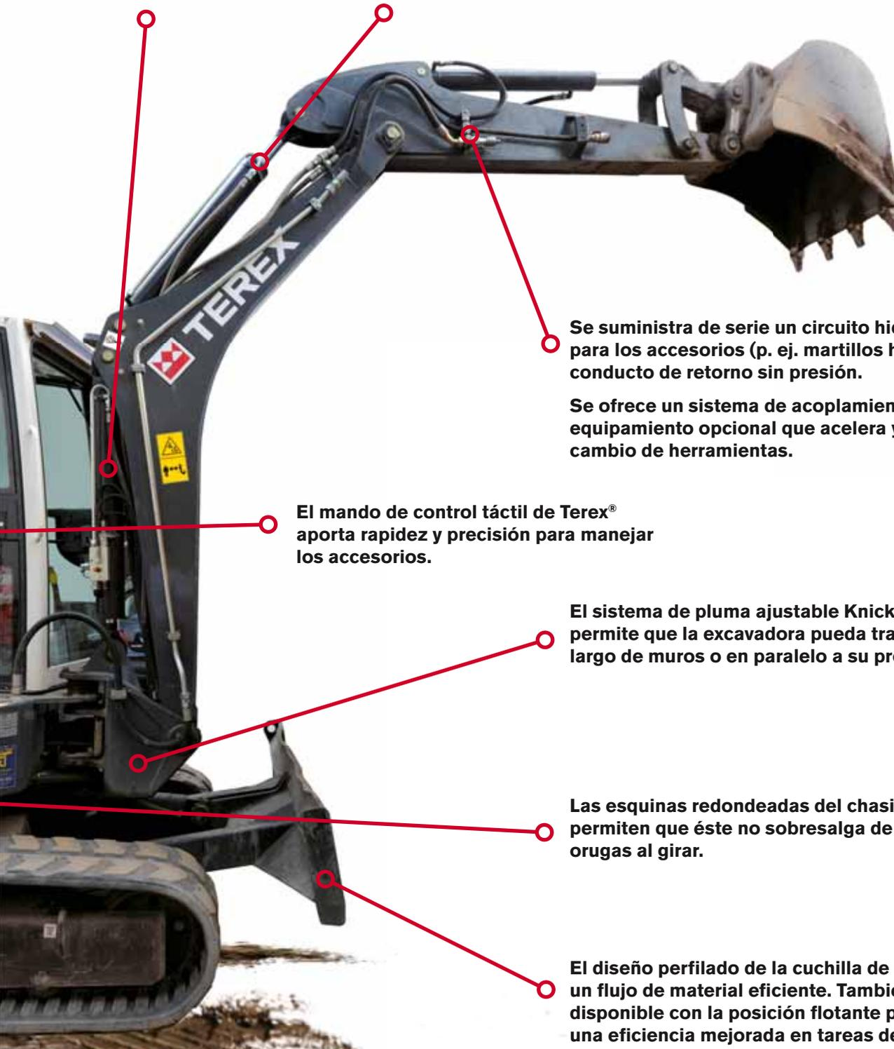
Se suministra de serie un circuito hidráulico auxiliar para los accesorios (p. ej. martillos hidráulicos) y un conducto de retorno sin presión.
