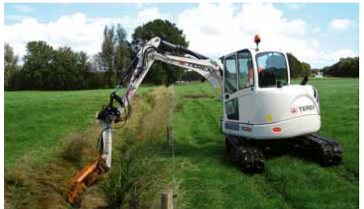
Nuestro sistema de pluma Knickmatick® permite que el operador pueda conducir en paralelo a una zanja o un sumidero mientras trabaja sobre ellos sin tener que girar la superestructura.
