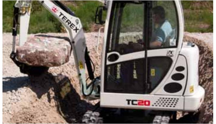
Las cargas se pueden sujetar fácilmente entre el balancín y la pluma.
