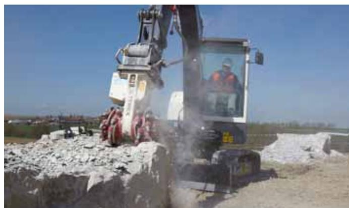
Por medio de las grandes reservas de aceite hidráulico presente en el circuito hidráulico auxiliar, es posible controlar la excavadora de manera precisa en todo momento; además, podrá utilizar la cuchilla, el taladro y el martillo de manera productiva.
