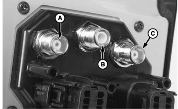
**A—Conexión para cable coaxial de la antena de telefonía móvil (CELL)**
