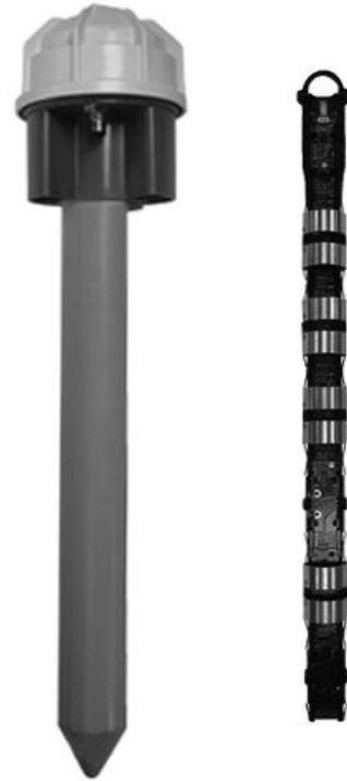
La sonda de humedad de suelo es un componente clave del sistema. La sonda de humedad de suelo coloca un sistema de sensores en la zona de la raíz del cultivo para facilitar la medición precisa y directa de la humedad del suelo en varias profundidades. El sistema de sensores se calibra en la caja del tubo de la sonda de humedad de suelo al instalarse. No instalar un sistema de sensores en una caja diferente.
