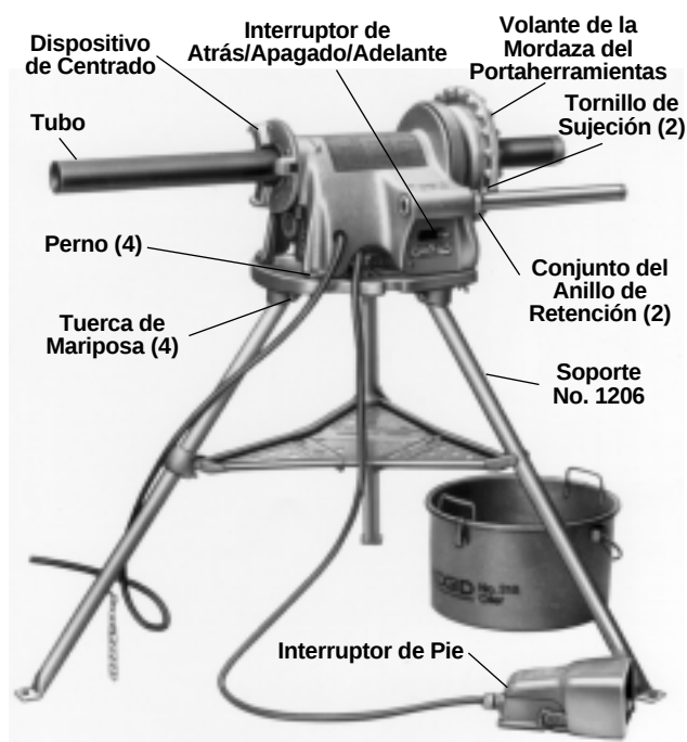
Figura 3 – Accionamiento autopropulsado con el tubo instalado, soporte y aceitera No. 318
