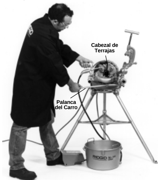
Figura 10 – El roscado de tubo con el cabezal de terrajas de apertura rápida o de autoabertura
