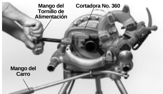
Figura 9 – El Corte de Tubos con la Cortadora No. 360
