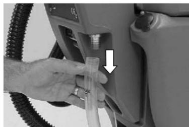
**4.** Retire y limpie el filtro del depósito de disolución.
