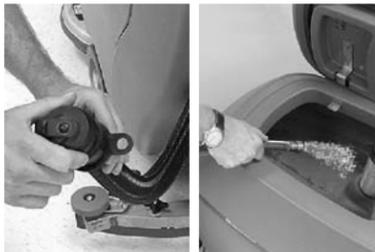
**2.** Retire y aclare el filtro del depósito de recuperación.
