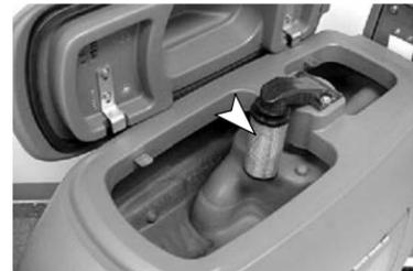
**6. Modelo FaST -** Compruebe el nivel de FaST-PAK. Sustituya el PAK si es necesario.
