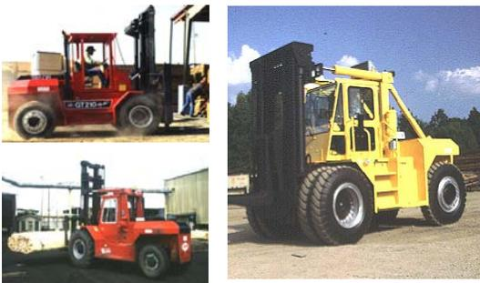
Montacargas de Alcance Extendido y de Terreno Áspero
