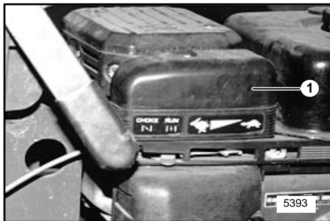
FIGURA 10 1. Cubierta de la Válvula de Regulación
