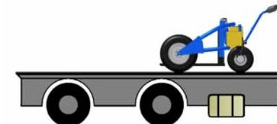
La rampa para la conducción de la transpaleta hacia el camión debe tener suficiente resistencia para soportar el peso de la transpaleta vacía y la sobrecarga debida al movimiento vertical de la transpaleta.
