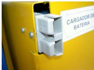
3. Conectar el cable del cargador a la transpaleta (solamente hay una posición de conexión para evitar
