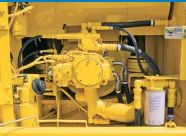
La alimentación hidráulica a las bombas principales está posicionada de modo tal que toma fluidos del lateral del tanque hidráulico, en lugar del fondo del tanque como muchos competidores. El sistema hidráulico posee un sistema de filtración de gran capacidad y pequeñas partículas para ofrecer los mejores intervalos de mantenimiento de la industria.
