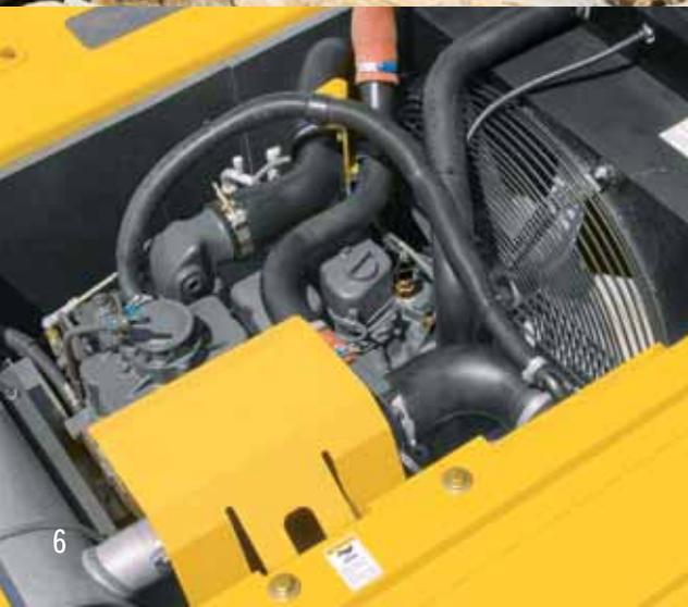
El confiable motor de 4,5  $\ell$  (275 pulg<sup>3</sup>), 4 cilindros y turbocargado IVECO de FTP<sup>MR</sup> ofrece un par máximo de 525 Nm (387 lbpie).
